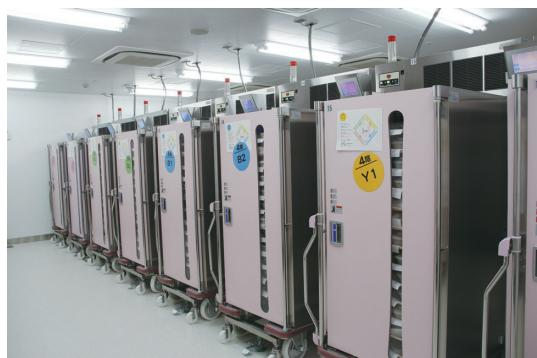
当院では新病院の移転と同時にニュークックチルシステム(調理後急速冷却し一定期間チルド温度帯にて保管後、再加熱して提供するシステム)を導入しています。
